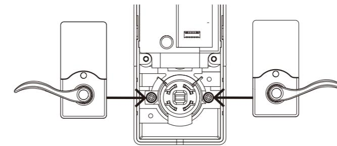
Db Retire el tornillo de la parte posterior del conjunto del teclado. Gire la manija a la posición deseada, luego vuelva a instalar el tornillo en el orificio que se muestra a continuación.
