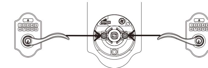
Dc Si su estilo de manija es simétrico (no tiene un extremo acampanado o curvo), omita este paso. Puede ser necesario cambiar las palancas después de girar la manija a la posición deseada. La punta de las manijas debe apuntar hacia abajo.
