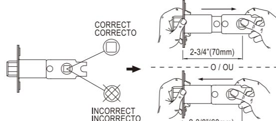
Cb Si el borde de su puerta no tiene una esquina cuadrada o redondeada cortada alrededor del orificio para el pestillo, ajuste el pestillo como se muestra.
