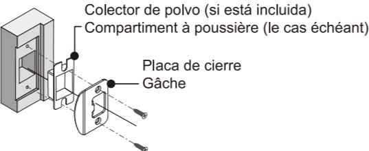
Use la placa de cierre como plantilla para perforar el pestillo y los orificios de los tornillos y cincelar la muesca. La placa de cierre debe quedar a ras de la superficie de la jamba de la puerta. El orificio debe tener al menos 1 in (25 mm) de profundidad.
