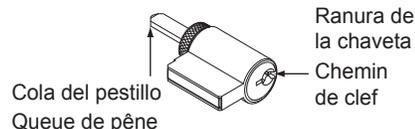
**5** Instalar el núcleo del cilindro
