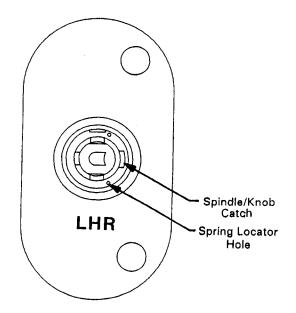
3. POSITION KNOB CATCH AND SPRING LOCATOR HOLE AS SHOWN BELOW.
