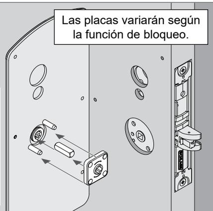
6b Instale la placa con dos tornillos, pero no los ajuste completamente. Si es necesario, alce sobre la placa interior para alinear los puntales.
