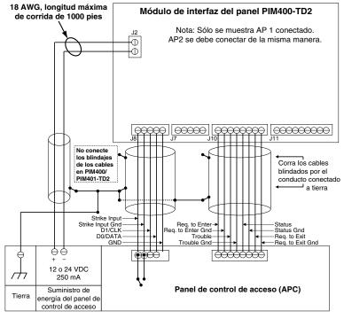
Nota: Se muestran las entradas del panel conmutadas a tierra, sin supervisión. Algunos paneles de control de acceso requieren entradas supervisadas y/o entradas aisladas de "contacto seco". El RLBD (Tablero de Relé de Sontacto Seco) de Schlage opcional está disponible para estas aplicaciones.
